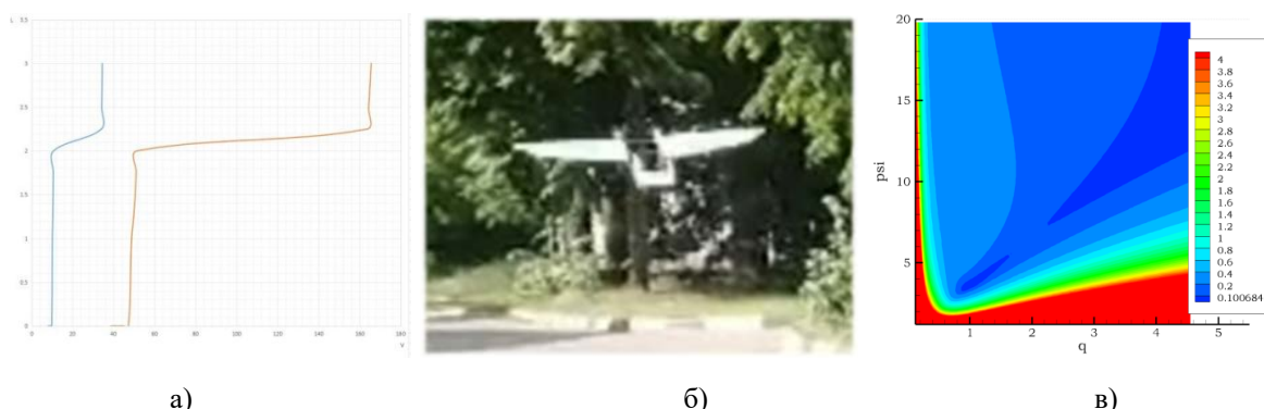
Рис. а) - зависимости характерного размера от скорости летательного аппарата для обеспечения горизонтального полёта, для атмосфер Земли и Марса, б) - фотография модели самолета-носителя, предназначенного для запуска сверхзвуковых автономных летательных аппаратов, в) – пример зависимости коэффициента сопротивления степенного тела в двухфазном потоке от показателя степени q и отношения максимальных продольного и поперечного размера.
